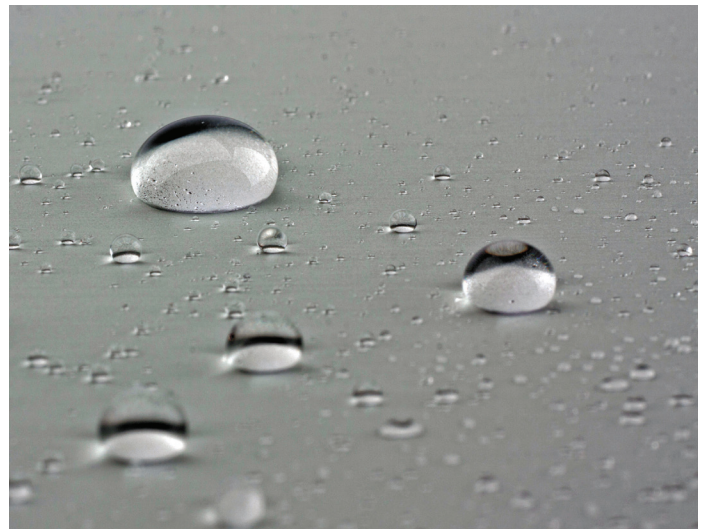
Abb. 4 // Hydrophob und oleophob wirkende Sol-Gel-Schichtoberfläche (Gruppe 3) auf Aluminium
