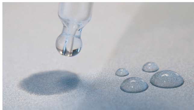
Abb. 6: Das Bild zeigt den Unterschied der «Farbabweisung» von der alten Oberfläche (links: Chrom) und der neuen TransferJacket Plus - Oberfläche (rechts: Nano-Sol-Gel-Schicht) mit einer farblosen Testflüssigkeit, die die Farbeigenschaften simuliert.
